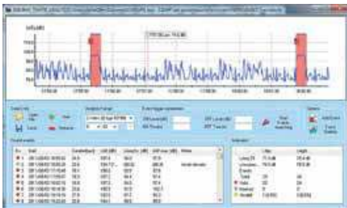
NS2A "Inquinamento Acustico": analisi sulle 24 ore con ricerca automatica dei transiti dei convogli ferroviari.
